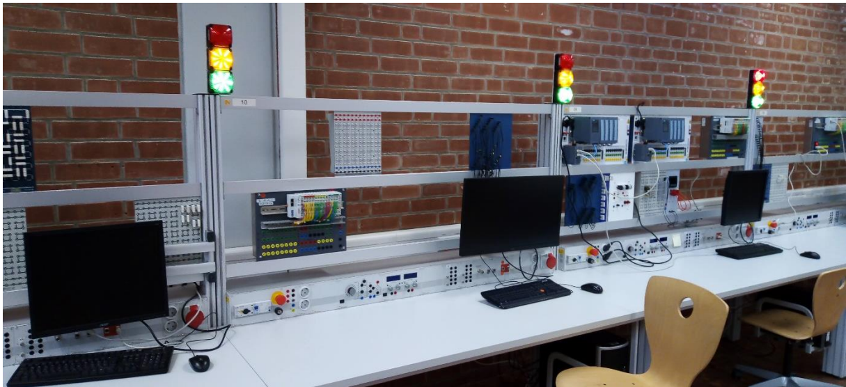
Obrázek 5 - Učebna automatizace: pracoviště výuky elektrotechniky a PLC
